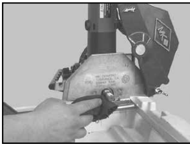
(D) Clean around Motor Shaft
